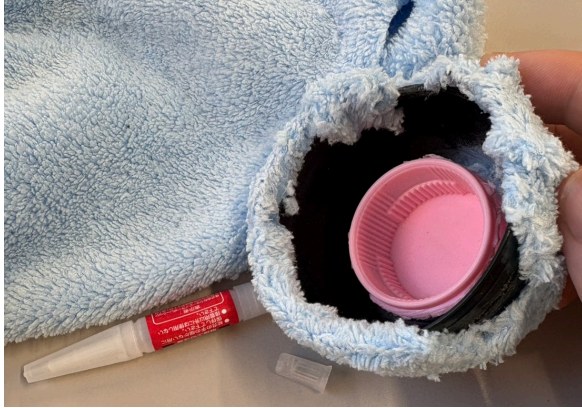
②保護と、保持力UPの為に本体に布を接着する。 ③本体に面ファスナー付きのバンドを接着
